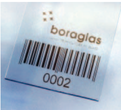
Abb. 1: Foto eines chemisch modifizierten Objektträgers (Bioslide), der durch \text{Na}^+ - \text{Ag}^+ -Austausch und \text{CO}_2 -Laserbestrahlung mit einem Barcode versehen wurde.
